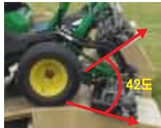
지면추종시스템 - 36도 좌·우 변위각 (각 방향18도), 42도 상·하 변위각 (각 방향21도)으로 지면 추종성이 뛰어남 (업계최대)
