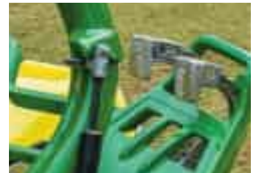
전·후진 분리형 페달 - 전·후진 분리형 페달로 조작이 쉽고 편함 - 오토페달 장착으로 속도에 따라 rpm보정 (자동차와 같은 원리) 조작법이 친숙함
