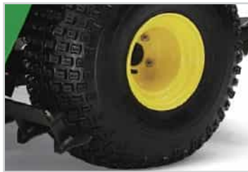
광폭 하이러그 타이어 - 전방 : 22.5X10-8 / 후방 : 25X12-9 타이어 장착, 슬립현상 없는 등판력
