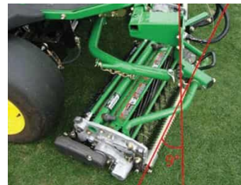
볼 조인트 서스펜션 - 좌·우 스윙각도 18도, 정밀 예지 작업 - 스캘핑 데미지 최소화
