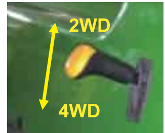
매뉴얼 타입 2WD & 4WD 변환 레버 - 작업 환경에 따라 레버식 구동 변환
