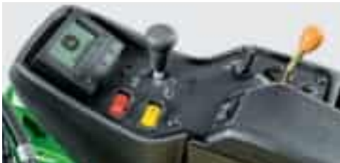
TechControl Display (존디어 특허방식) - 깎기속도 및 이동속도 정밀설정가능/ 작업속도 자동제어 - 테크컨트롤 화면을 통한 장비 상태 및 고장 진단
