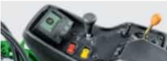
TechControl Display (존디어 특허방식) - 각기속도 및 이동속도 정밀설정 가능 / 작업속도 자동제어 - 테크컨트롤 화면을 통한 장비 상태 및 고장 진단
