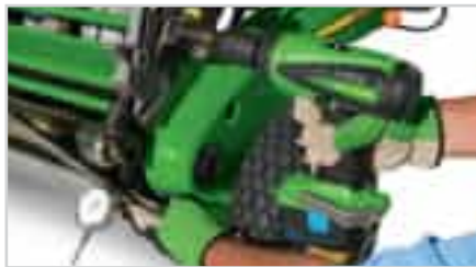
스피드링크 시스템 - 양방향 동시 예고조절 방식
