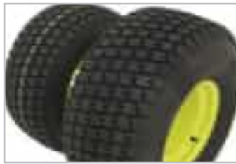
광폭타이어 장착 - 잔디 손상 최소화 및 구동력 증대
