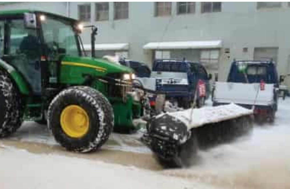
유압 증폭 KIT 장착 - 대량의 눈을 제설하기 위해 별도 유압 증폭 KIT 장착
