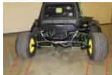
잔디용 광폭타이어 (타이어 자국 최소화) - 등판력 향상 - 전방: 26.5X14-12, 후방: 20X12-10
