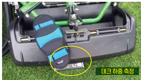
폴통 리프트 암 장착 - 예지물 양과 상관없는 일정한 예고 작업 / 일정한 그린스피드 유지 (폴통 무게로 인한 스캘핑 및 예고변화 방지)
